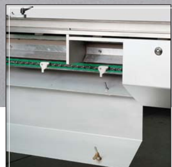
Cinta de alimentación con puertas abatibles Infeed conveyor with side hinged panels Convoyeur d'alimentation avec des portes abattibles
