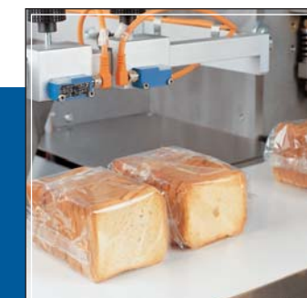
Conjunto expulsor de bolsas vacías y/o dobles Device for detection and reject of empty and/or double packs Dispositif de détection et rejet de sachets vides et/ou doubles
