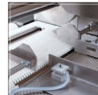
Fotocélula función NO FASE-NO CORTE NO GAP-NO CUT sensor device Photocellule avec fonction HORS DE PHASE-PAS DE DECOUPE
