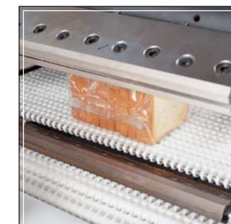
Cinta de arrastre motorizada en soldador - cortador Motorized conveyor in the transversal sealing-cutting group Convoyeur d'entraînement dans le groupe coupeur soudeur
